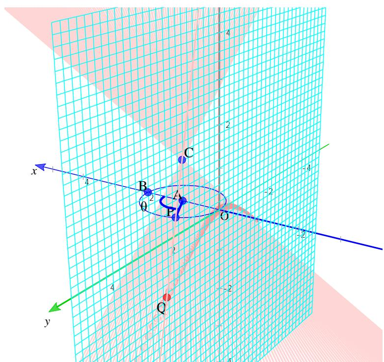
直線CPの軌跡は頂点で向かい合う円錐となるので、母線に平行でない平面であるyz平面での切り口は双曲線となる。
